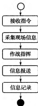
图 5.3.1 现场指挥子系统基本工作流程
